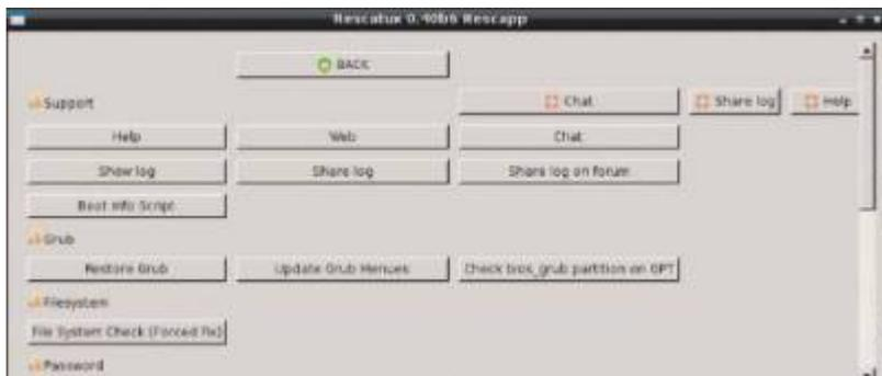
**Notfallsystem:** Nach dem Start von Rescatux rufen Sie die Reparaturfunktionen über Rescapp auf. Sie können beispielsweise den Bootmanager Grub reparieren oder das Anmeldepasswort für Ihr Linux-System neu setzen.
