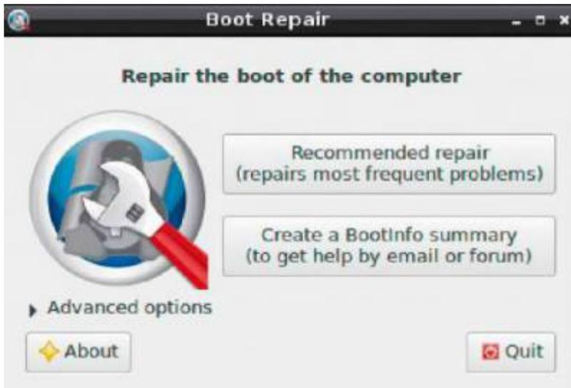
**Bootumgebung wiederherstellen:** Boot Repair ermöglicht die Grub-Reparatur mit einem Klick. Unter „Advanced Options“ stehen aber auch Profifunktionen zur Verfügung.
