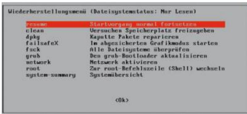
**Wiederherstellungsmenü einsetzen:** Im Recovery Mode zeigt Ubuntu ein einfaches Auswahlmenü, über das Sie eine Reihe von Reparaturfunktionen oder die Kommandozeile für weitere Maßnahmen aufrufen können.
